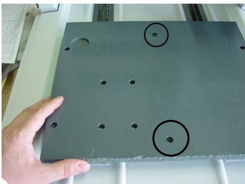
Déplacer le plateau légèrement pour positionner le trou de la vis centrale du bas et la mettre en place.
