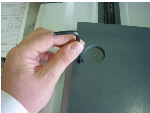
Positionner les vis, puis serrer en tournant avec la clef hexagonale. Finir le serrage.
