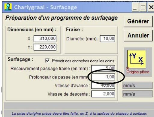
Ne pas prendre une trop grande profondeur de passe avec une broche de 600W et une fraise de 10 ou 15 mm de diamètre.
