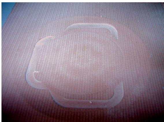
Etat de surface rayé. La hauteur de crête choisi est trop important. Pour améliorer l'état de surface, soit diminuer la hauteur de crête (cela augmentera le temps d'usinage) soit faire une demi finition avec une fraise hémisphérique de plus gros diamètre.
