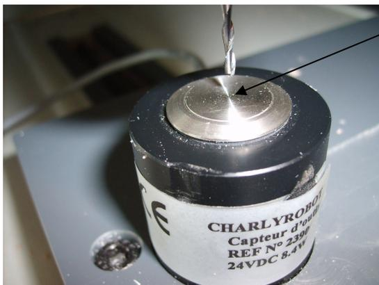
Il faut positionner l'outil le plus au centre du capteur d'outil.
