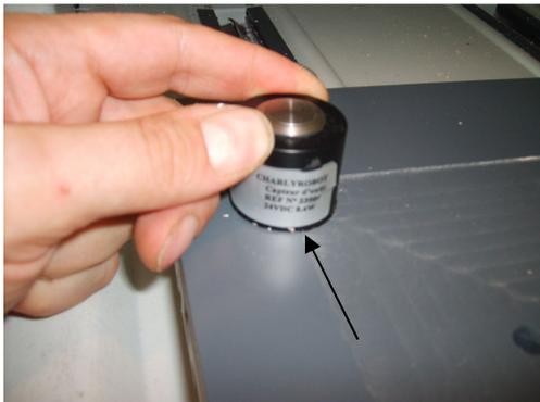
Mettez deux gouttes de cyanolite (super glue) ou un morceau de double face sur le dessous du capteur pour le maintenir.
