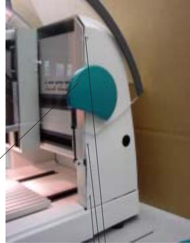
Pour accéder à l'axe X démontez la capot avant (mobile) ouvrez le capot arrière en ayant pris soin de déconnecter la prise d'alimentation.
