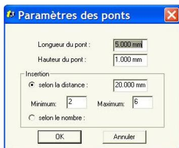
Pour insérer des ponts, la première méthode est de donner une distance minimum, et un nombre minimum et maximum de pont, le logiciel place ensuite le nombre minimum de ponts et selon la distance, il met des ponts jusqu'au maximum de ponts prévus.
