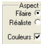
La simulation réaliste permet de voir à l'écran l'usinage s'effectuer sur un brut matérialisé avec des couleurs et des ombrages. Elle est le reflet très fidèle de l'usinage qui sera effectué sur la machine. La simulation rapide permet de voir à l'écran l'usinage s'effectuer en représentation filaire.
