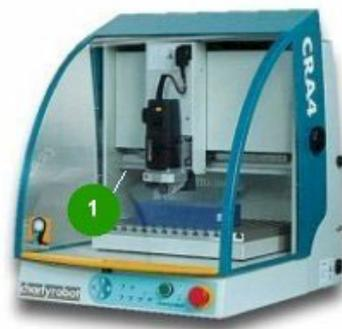
Le connecteur du capteur d'outil se trouve derrière la poutre en aluminium (1).
