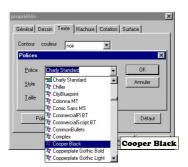
puis créer le symbole pour le potentiomètre (un arc de cercle, puis sa rotation depuis le point de gauche. Placer une droite reliant les deux arc).
